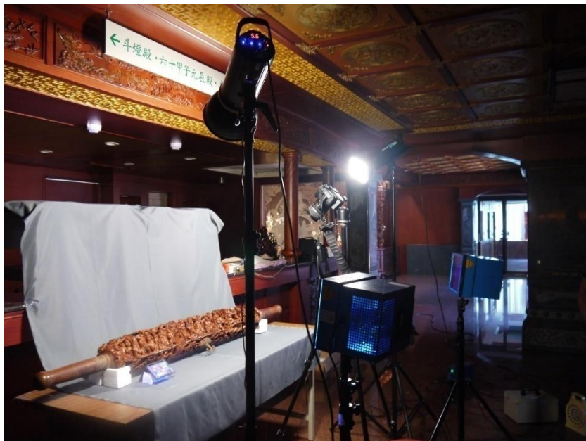
圖 1-2-11 架設紫外線燈拍攝木質文物
