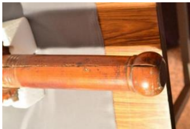
圖 6-3-3 鑼桿使用一段時間後於髓心處產生明顯的開裂現象（本研究團隊拍攝）
