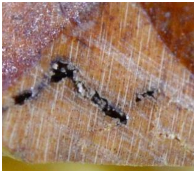
狗骨仔木材之橫切面細胞(實體顯微鏡)
