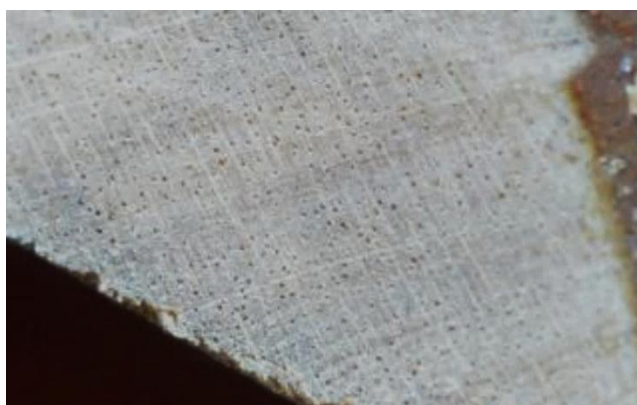
狗骨仔木材之橫切面細胞(實體顯微鏡)
